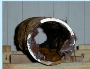
État des canalisations posées en 1960 en fonte avant remplacement
